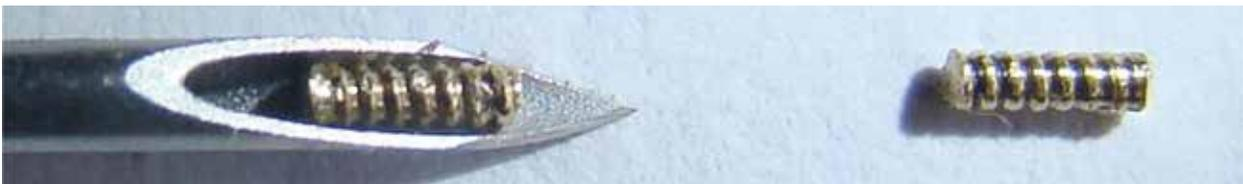
Figura 4 | Fragmentos de ouro para implante em pontos de acupuntura: frações de filamentos de ouro 750 (18 K) inseridos em bisel de agulha hipodérmica (foto do arquivo VetCar, gentilmente cedida pelo médico veterinário Eduardo Diniz da Gama).
