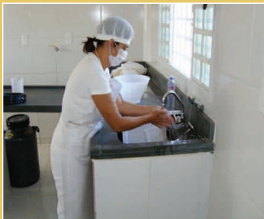
Figura 11 – Paredes impermeabilizadas com azulejo permitido no anexo 22, todos os móveis de material permitido, fabricantes com uniformes de proteção contra contaminação dos produtos.
