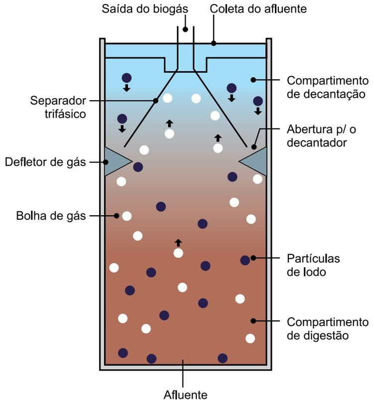
Figura 10 – Esquema de funcionamento de um reator anaeróbio UASB<sup>8</sup>
