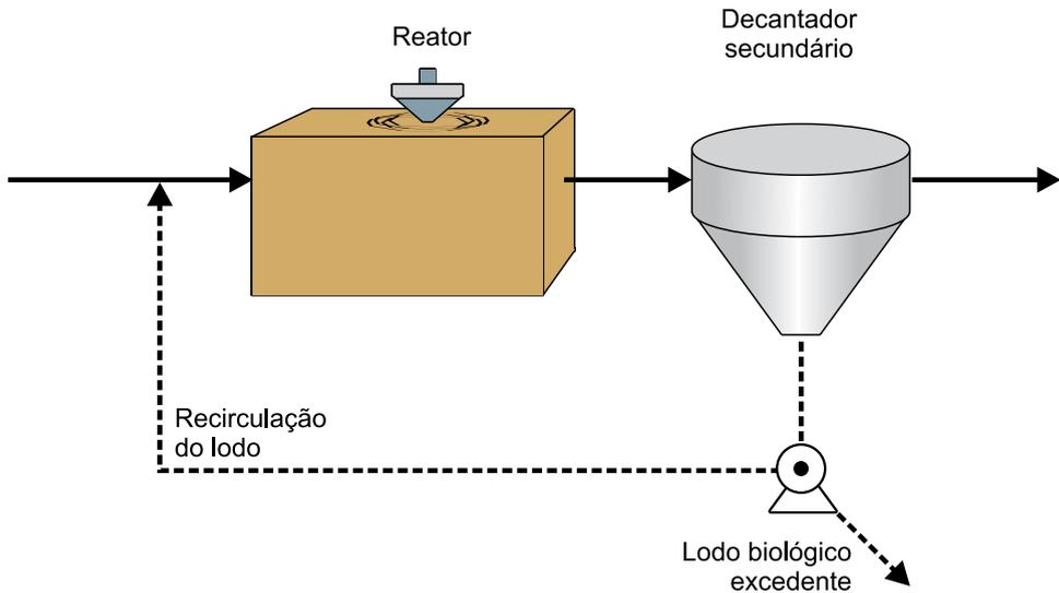
Figura 8 – Esquema e funcionamento do sistema de lodos ativados<sup>2</sup>
