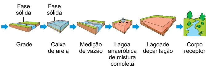
Figura 7 – Variantes do sistema de lagoas de estabilização<sup>2</sup>
