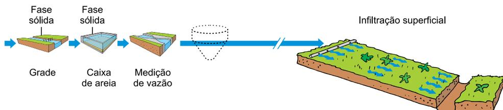
Figura 12 – Esquema de funcionamento das diversas modalidades de sistema de disposição no solo<sup>2</sup>
