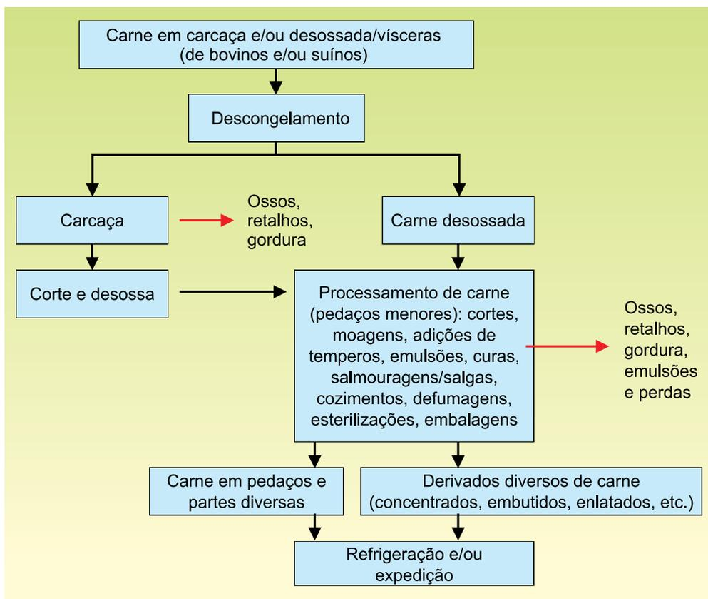
Figura 4 - Fluxograma da indústria de processamento<sup>18</sup>
