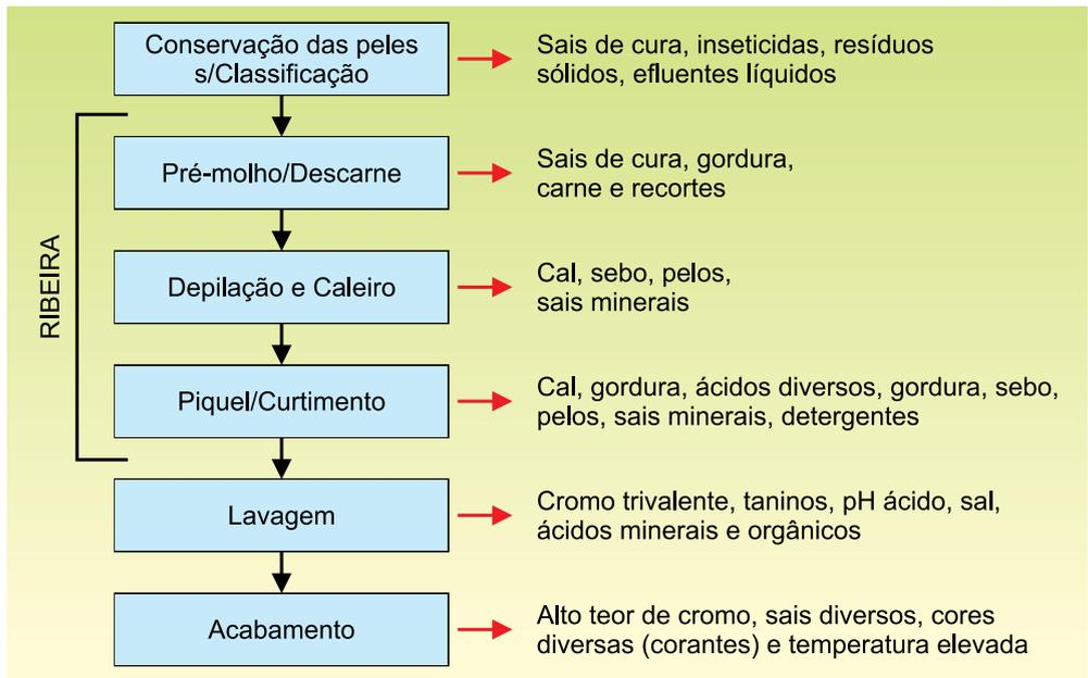
Figura 6. Fluxograma de um curtume<sup>18,21</sup>
